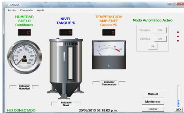
**Fig. 17** Interfaz grafica de usuario dispositivo HID conectado
