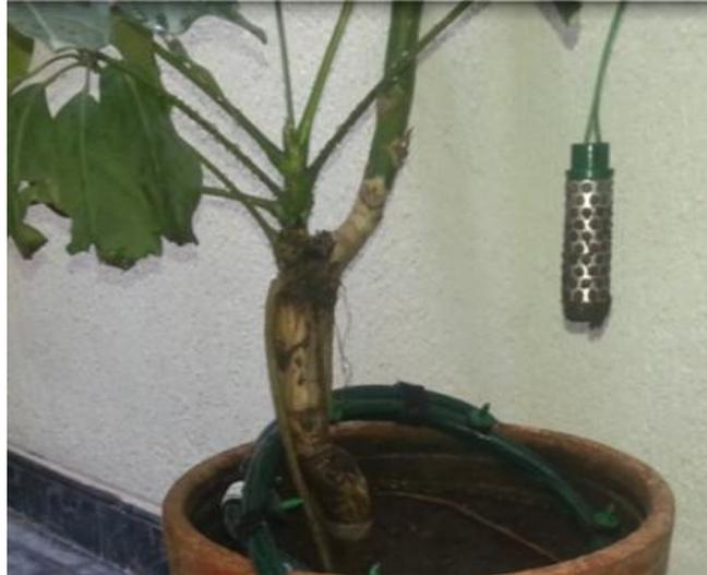
**Fig. 12** Sensor de humedad del suelo Watermark
