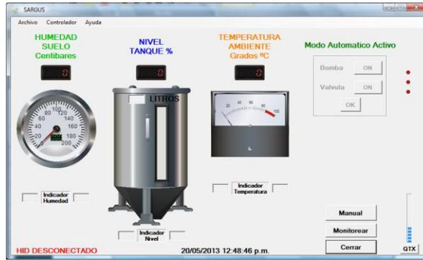
**Fig. 16** Interfaz grafica de usuario dispositivo HID desconectado
