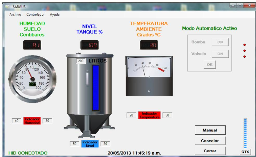
Se establece control manual sobre el sistema de riego con el botón manual, en este momento el dispositivo de control no actúa sobre la electrobomba y la electroválvula, es el usuario el encargado de tomar la decisión de encender o apagar electrobomba y electroválvula.
