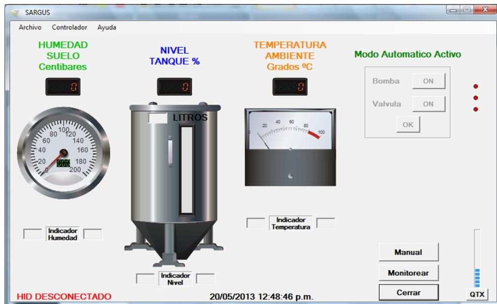
Al momento de conectar el dispositivo USB el computador lo detecta y la interfaz de usuario informa el cambio, en la parte inferior izquierda de la ventana se indica "HID CONECTADO", entonces es posible acceder al sistema de riego. En la parte inferior derecha se encuentra una barra de nivel que indica si el estado de transmisión y
