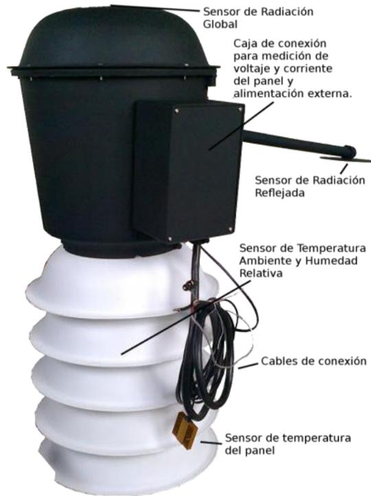
**Fig. 3.** Vista exterior del módulo Estación y sus sensores.
