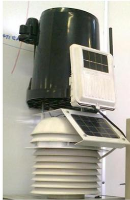
**Fig. 9.** Estación meteorológica Davis, durante las pruebas en ambiente cerrado.
