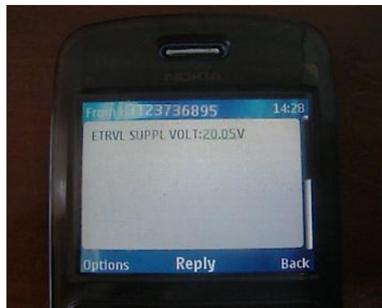
Figura 24. Resultado GPRS. Mensaje SMS con nivel de Voltaje del Modem.
