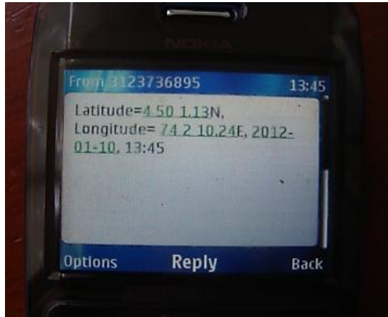
Figura 25. Resultado GPRS. Mensaje SMS con localización del GPS.
