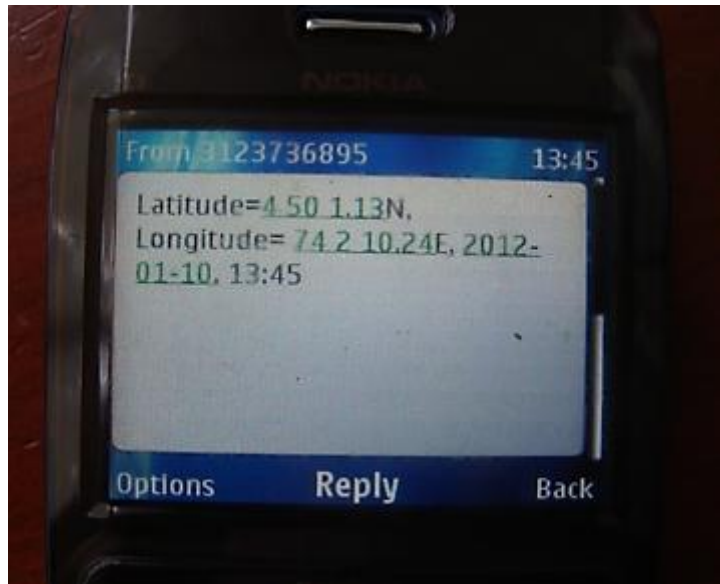
Figura 12. Mensaje SMS con información de localización del sensor con GPS.
