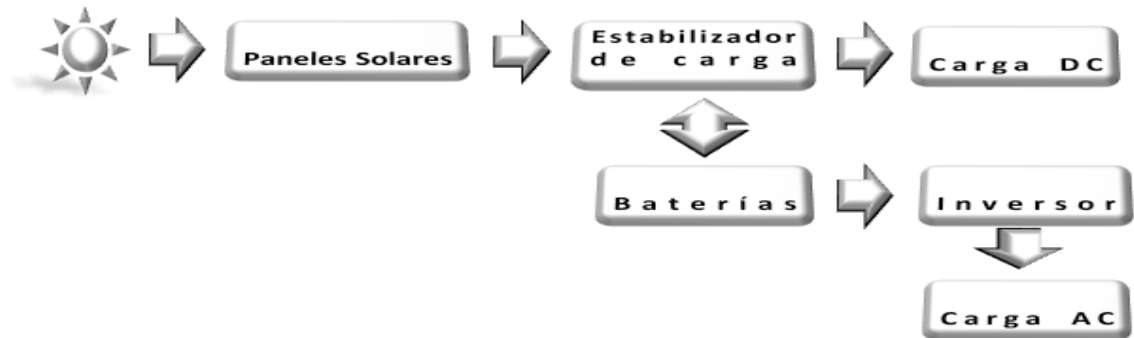
Figura 8 Sistema fotovoltaico Stand-Alone
