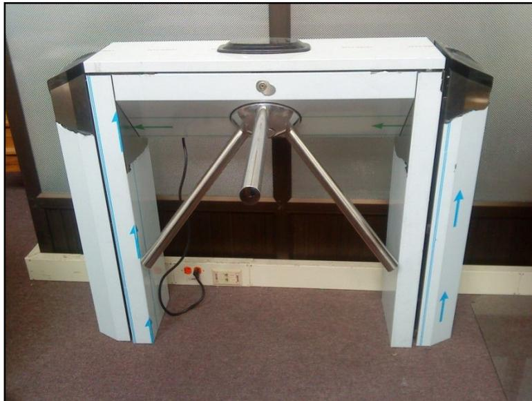
Es electromecánico bidireccional selectivo, realizado completamente con acero inoxidable AISI 304 con acabado "scotch-brite" y con tapa superior extraíble con cerradura y llave; patas laterales extraíbles. Cabeza del trípode de aluminio con acabado brillante y brazos de acero inoxidable brillantes.
