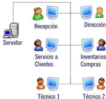
A su vez, las LAN tienen diferentes maneras de implementación, llamadas Topologías de red. La Topología de red hace referencia a la forma en la que se encuentran estructuradas las conexiones de una red LAN en el lugar donde se ha implementado, dependiendo de la distancia y la forma de comunicación entre los dispositivos. Existen diferentes topologías de red, entre las cuales encontramos
