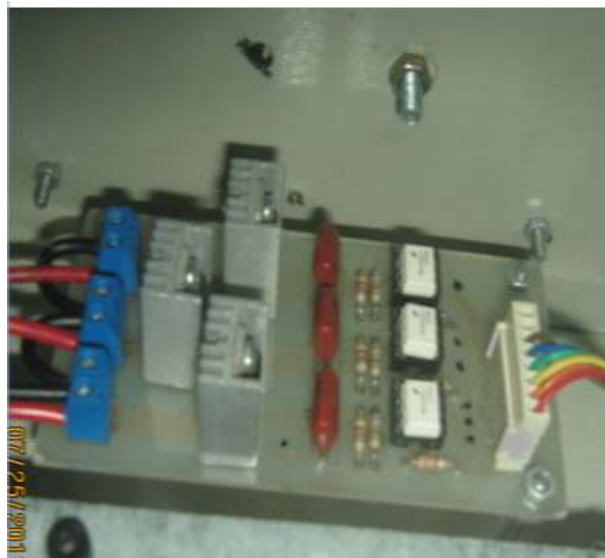
Figura 29. Salidas A.C. en el circuito real
