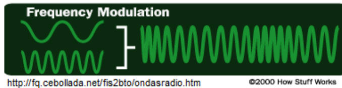
Figura 1. (Onda de frecuencia modulada).
