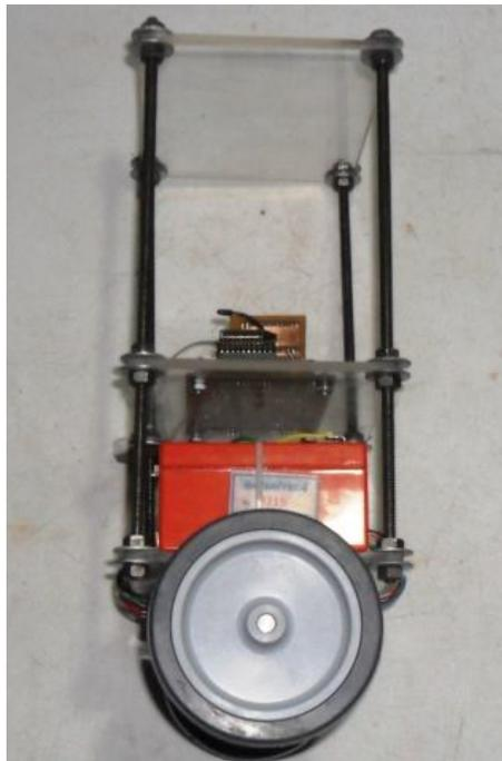
El tercer chasis y definitivo mostrado en las Figuras 24 y 25 se construyó mediante varias láminas rectangulares de 120 mm x 160 mm de metacrílateo con los componentes colocados en medio de cada placa, con una altura total de 30cm. Este diseño simple permite una rápida instalación de componentes y la altura da cada plataforma puede ser aumentada o reducida variando el centro de masa cuando se desee.
