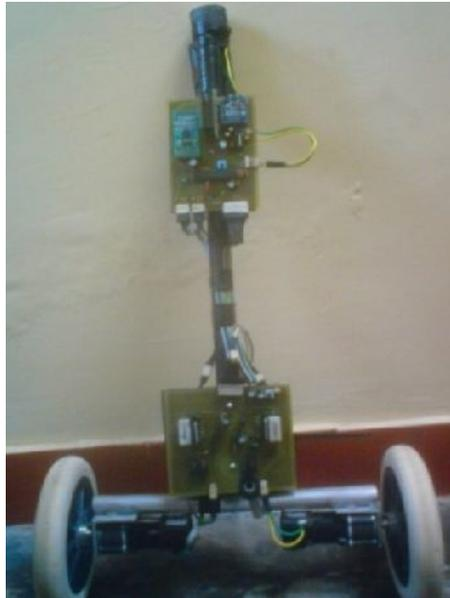
En este diseño se separaron las tarjetas de control y potencia debido a problemas de ruido eléctrico proveniente de los motores, además se cambiaron las ruedas y los motores logrando una mejora en su desempeño; Se logro estabilidad por periodos de tiempo cortos sin embargo la caja reductora de los motores y la poca resolución de los encoders limitaron el sistema haciendo imposible lograr un desempeño estable.
