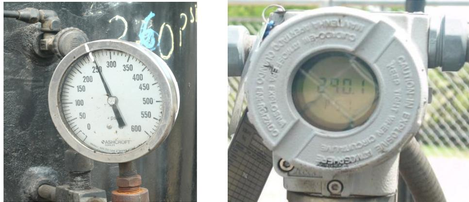
Figura 23. Manómetro análogo y sensor de presión digital
