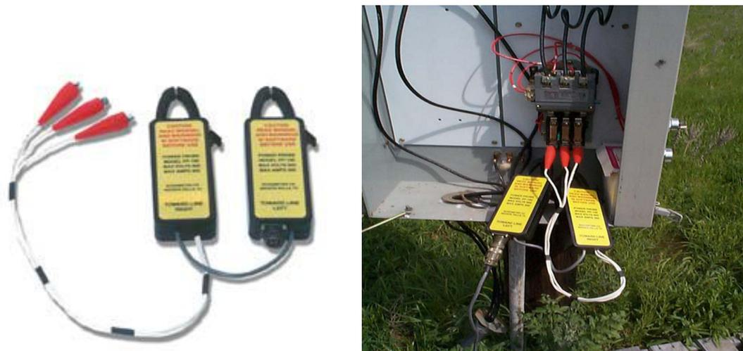
Figura 10. Transductor potencia-corriente
