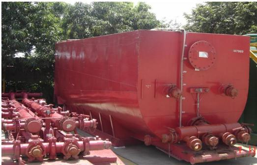
**Figura 1.3: Tanque de Fractura (FRAC TANK)**
