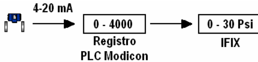
Figura 96. Proceso de conversión de una señal 4-20 mA
