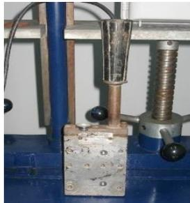
**Figura 5. Plancha de termofusión**
