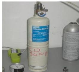
**Figura 4. Verificación con gases patrones**
