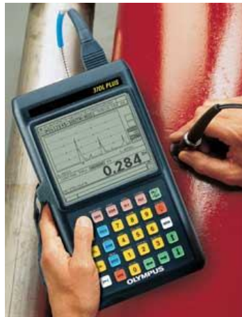
Figura 34. Equipo medidor ultrasónico portátil panametrics 37DL PLUS (Imagen tomada de http://www.espesor.37dlplus.com/ )
