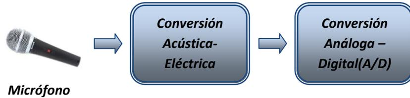
**3.1.1 Conversión acústica – eléctrica.** La adquisición de la señal de voz (comandos) pronunciado por el niño se inicia con la captura de la misma empleando para ello un transductor acústico (micrófono), que convierte la variación de la presión ejercida sobre su membrana en una señal eléctrica analógica que varía en el tiempo. Esta señal es introducida al computador mediante la conexión del micrófono a la entrada de la tarjeta de sonido.
