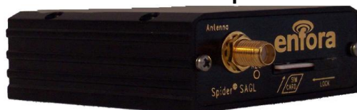
Figura 2: Módulo GSM/GPRS SA-GL con su respectiva SIM Card
