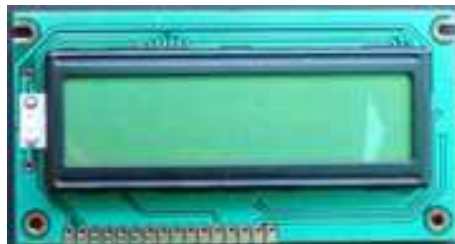
Figura 9. Display LCD de texto de 16x2 con controlador HD44780.
