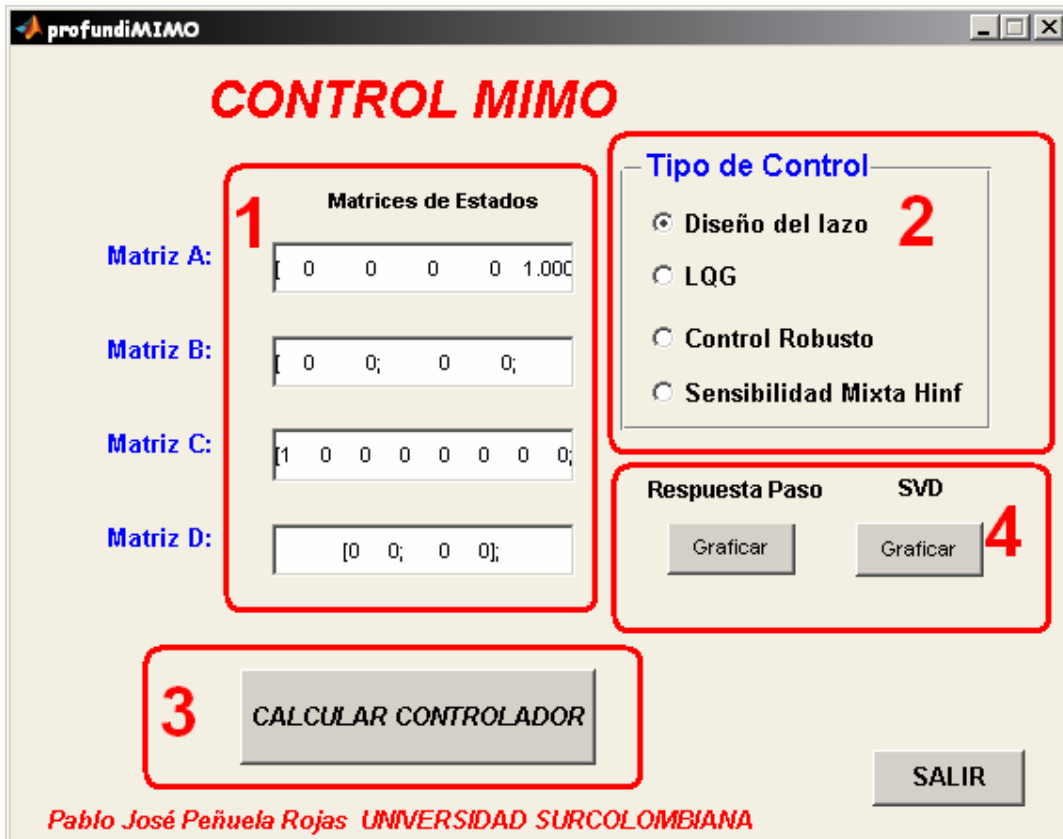
Figura 20: Pasos a seguir para diseño de Control Robusto
