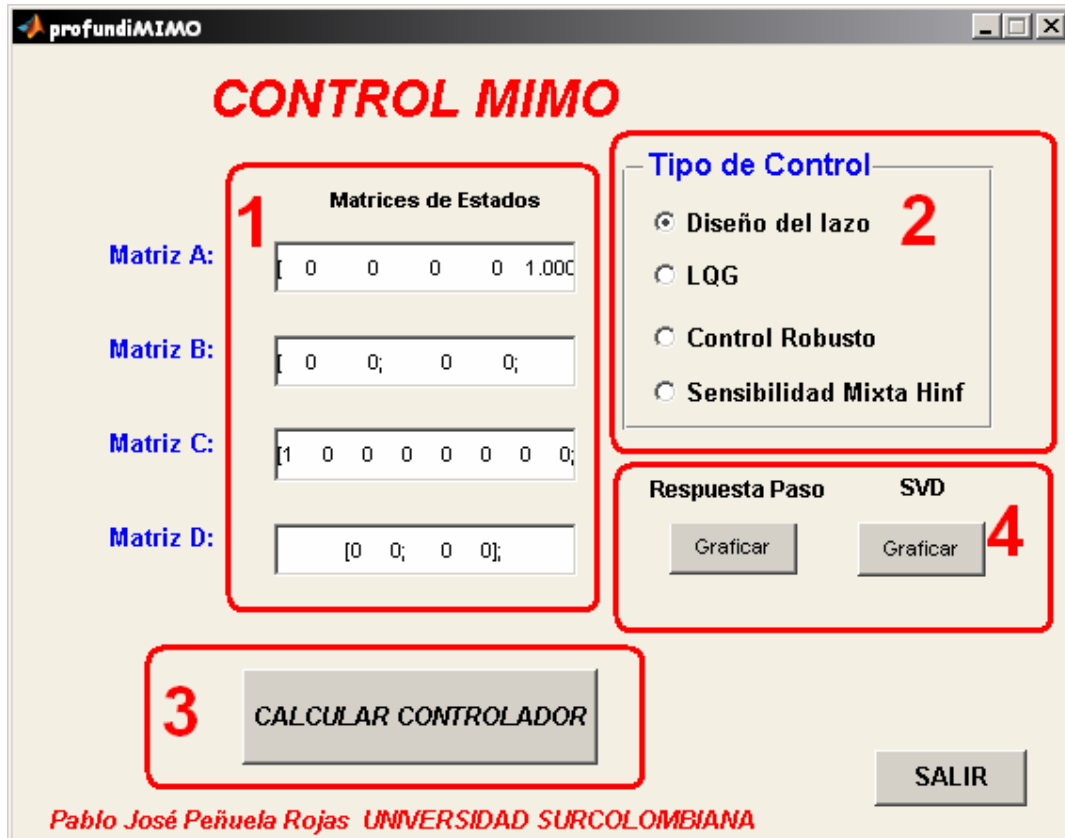
Figura 17: Pasos a seguir para diseño del controlador LQG
