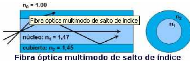
Figura 1.4.2.8 Fibra óptica multimodo de salto de índice
