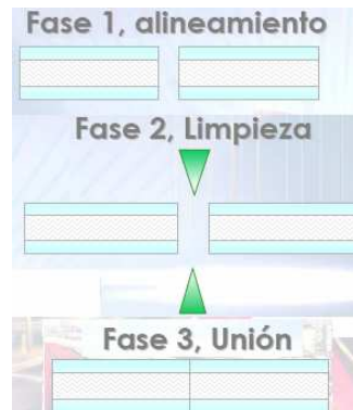
Figura 1.4.2.11 Empalme Fibra óptica
