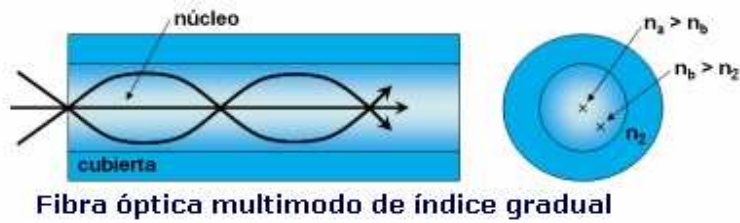
Figura 1.4.2.6 Fibra óptica multimodo de índice gradual
