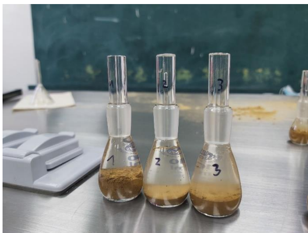
Figura 10: Montaje para la medición de la densidad real
