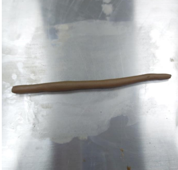
Figura 8: Ensayo para determinar la plasticidad del suelo mojado Fuente: Autoría propia
