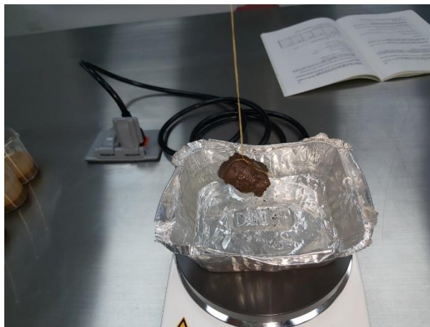
Figura 9: Montaje del método del terrón parafinado Fuente: Autoría propia
