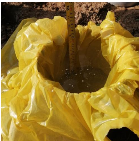
Figura 11: Montaje para la medición de la infiltración
