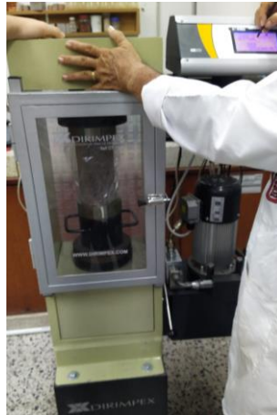
Ilustración 15. Máquina usada para la resistencia a la compresión.
