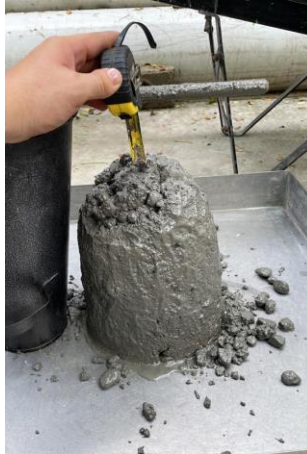
Ilustración 12. Medición del asentamiento.
