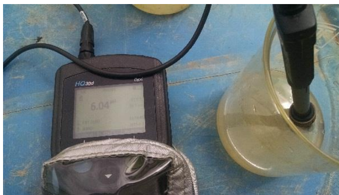
Fotografía 9. Medición de pH a través del pH-metro Fuente: Archivo fotográfico de la planta Palmarito 2013
