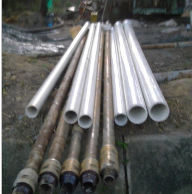
Fotografía 5. Tubería utilizada en la perforación del Pozo
