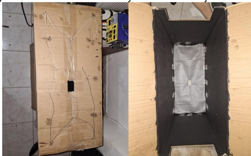
Figura 32. Instalación de LEDs y Difusor en la caja del sistema.
