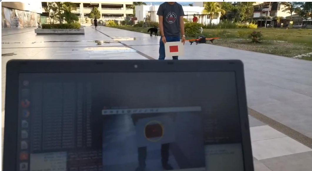
Figura 50. Detección de obstáculo con AR.Drone 2.0 en tiempo real.
