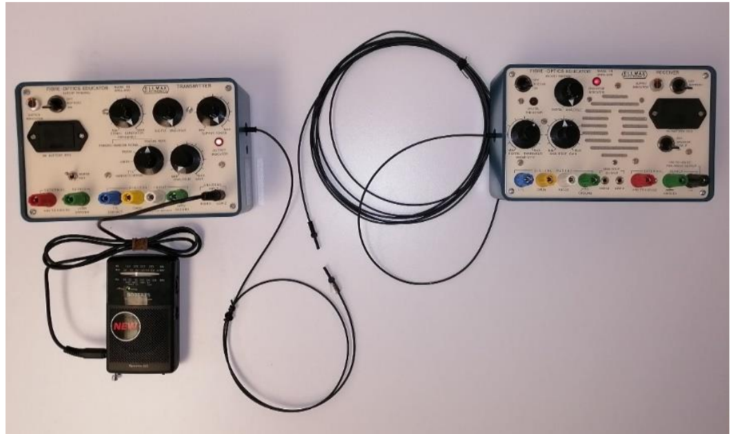
Figura 31. Módulos transmisor y receptor conectados por medio de dos hilos de fibra enfrentados
