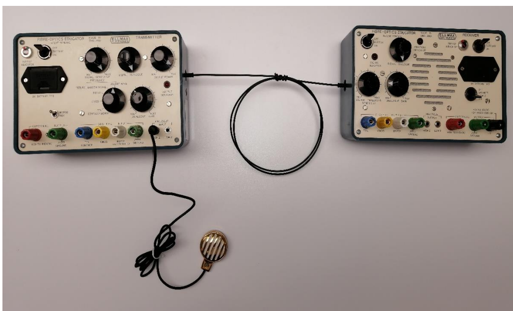
Figura 50. Modulo transmisor recibiendo una señal desde un micrófono
