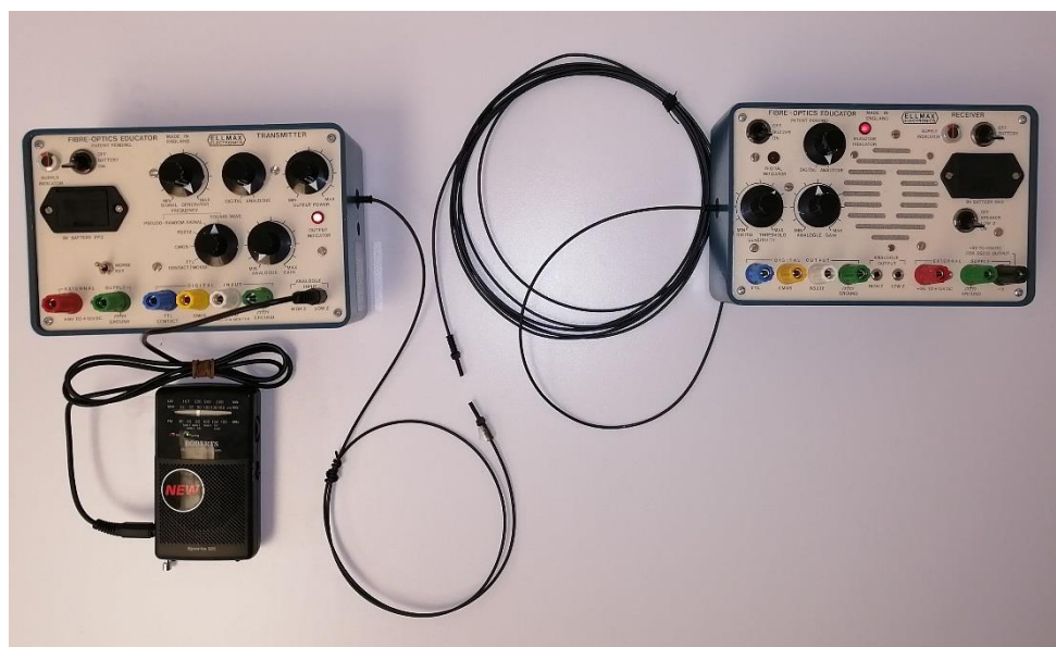
Figura 47. Módulos transmisor y receptor conectados por medio de dos hilos de fibra enfrentados
