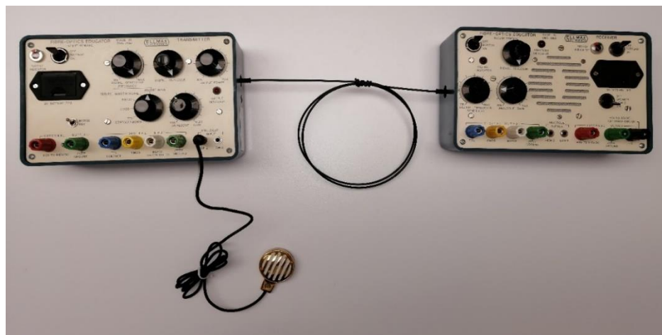
Figura 34. Modulo transmisor recibiendo una señal desde un micrófono
