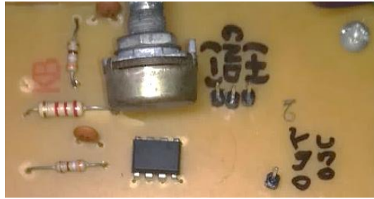
Figura 38. Oscilador puente de Wien.
