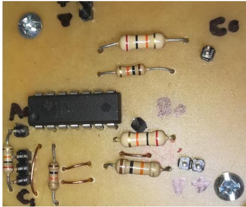
Figura 42. Acondicionamiento de las señales de control para el multiplexor.
