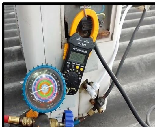
Figura 16 Corriente nominal experimental del compresor del Aire Acondicionado
