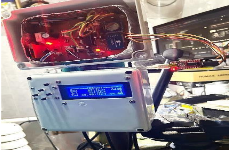
Figura 22 Montaje del circuito y baterías en cajas de PVC.
