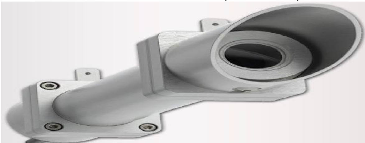
Figura 11 Fotografía de un pirheliómetro (fuente:
