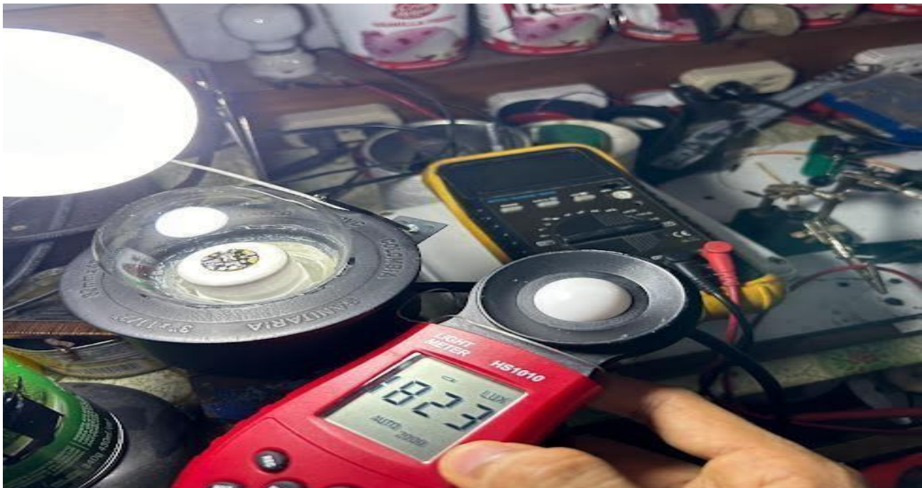
Figura 24 Proceso de calibración del sensor en modo luxómetro
