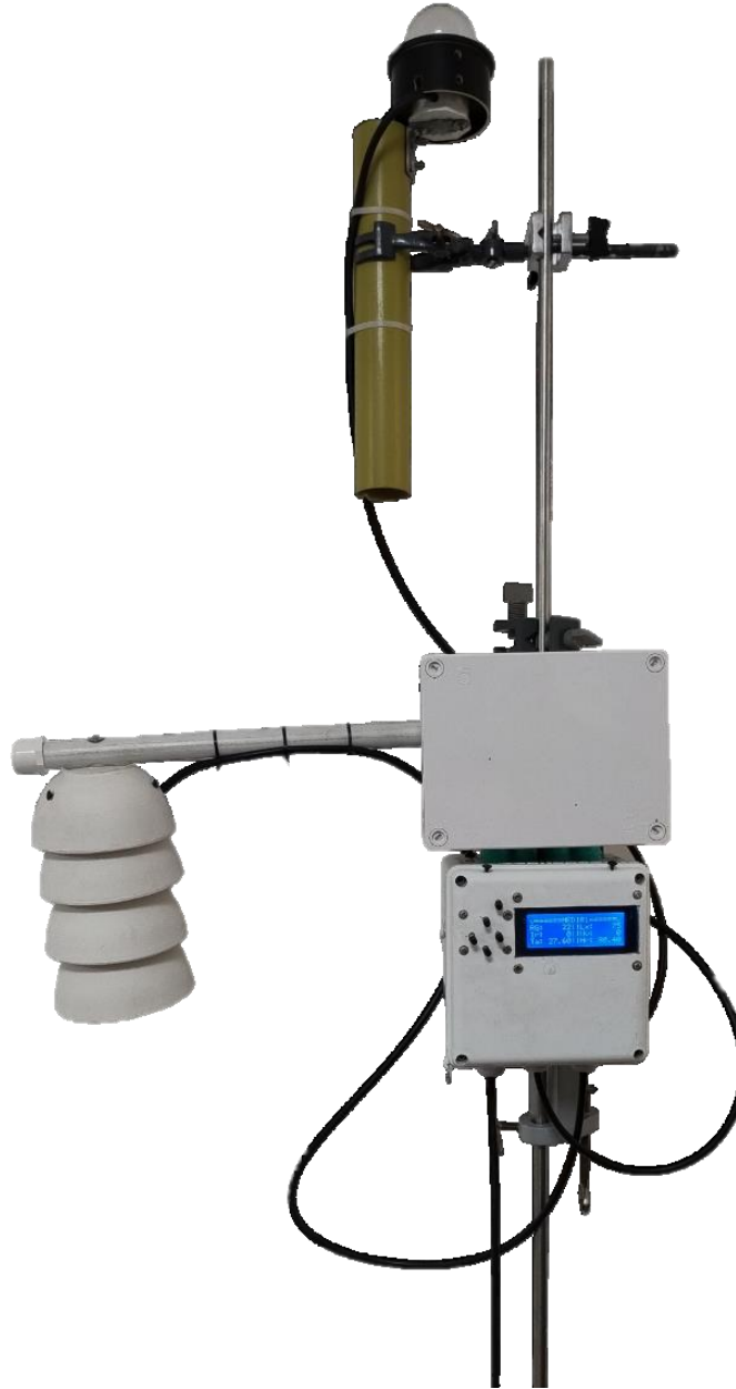
Ilustración 1 Montaje del Piranómetro
