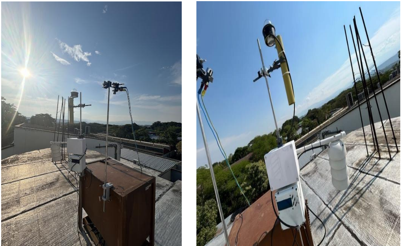
Figura 31 Montaje de los sensores en la azotea de laboratorios de ciencias exactas de la Universidad Surcolombiana.
