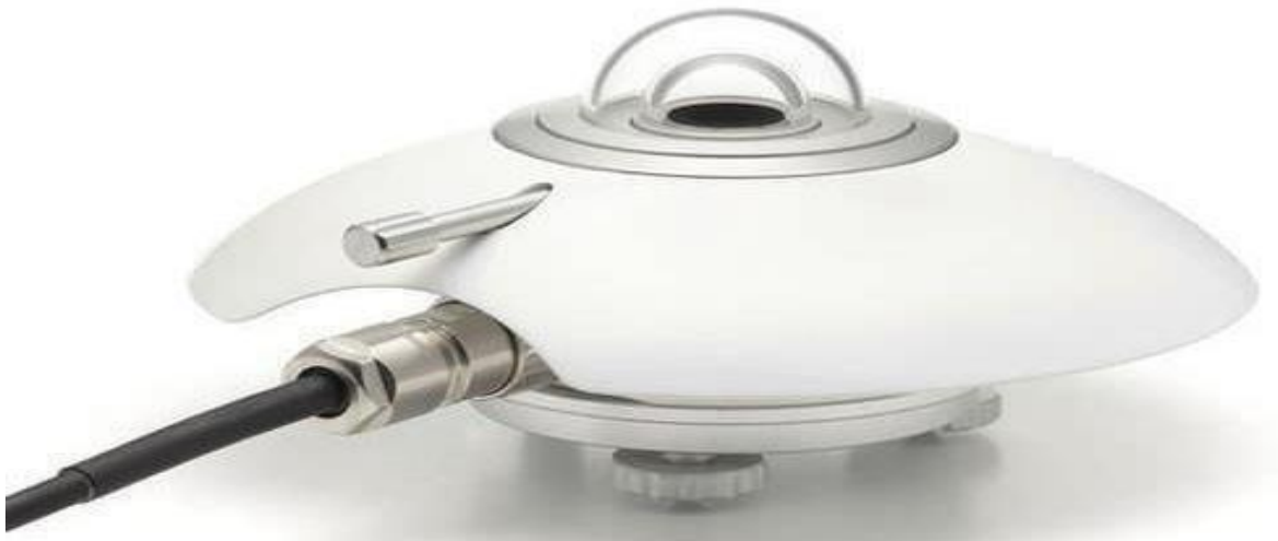
Figura 9 Fotografía de un piranómetro
