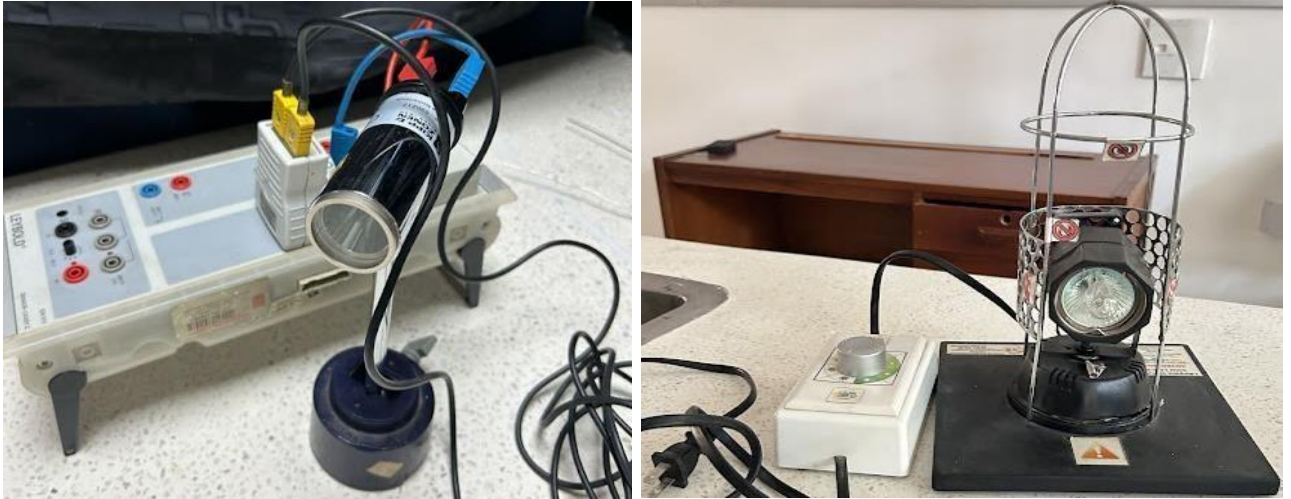
Figura 27 Modelo de referencia: termopila de laboratorio (kipp & zonen CA2) (izq) Lámpara Halógena de 120V y 300W @ 3200K (der)
