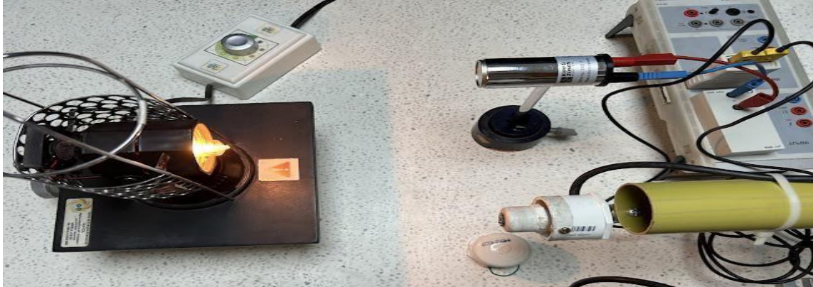
Figura 26 Preparación y disposición de los sensores frente a la lámpara halógena.
