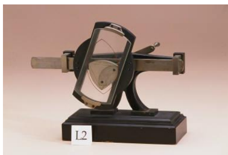
Figura 4.20: Modelo de rotacion del triangulo de Reuleaux.
