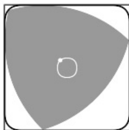
Figura 1.2: Plano base de la perforación de la broca del Ingeniero Watt
