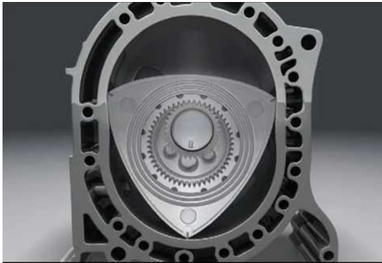
Figura 4.2: Triangulo rotatorio de un pulsador.
