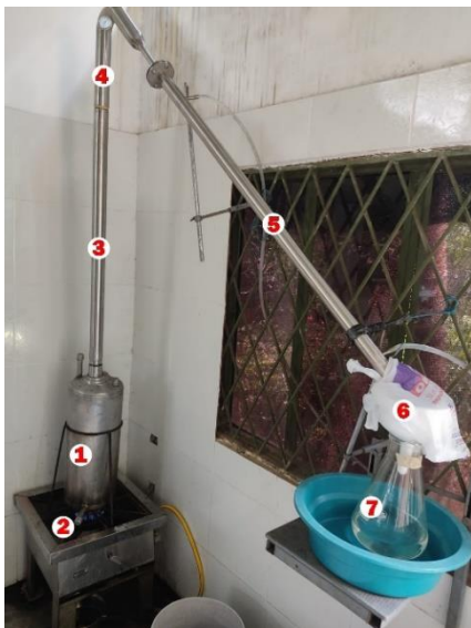
Figura 3-9: Sistema de destilación fraccionada para la extracción de licor de carambola.
