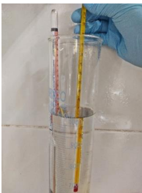
Figura 3-10: Medición de riqueza alcohólica real y temperatura en destilados.
