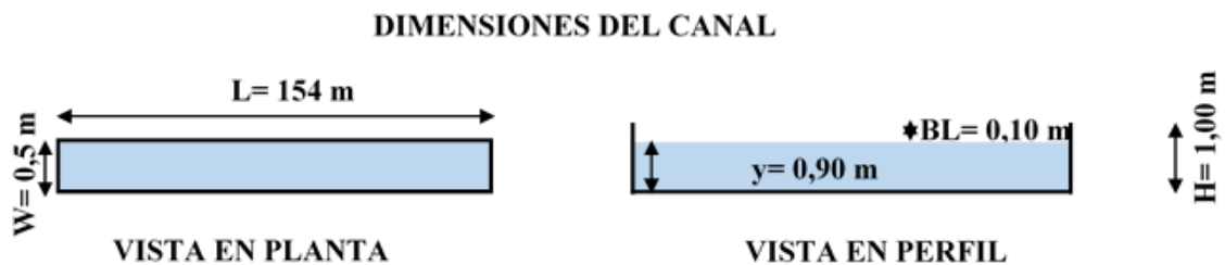
Figura 40. Dimensiones del Canal de Fitorremediación
