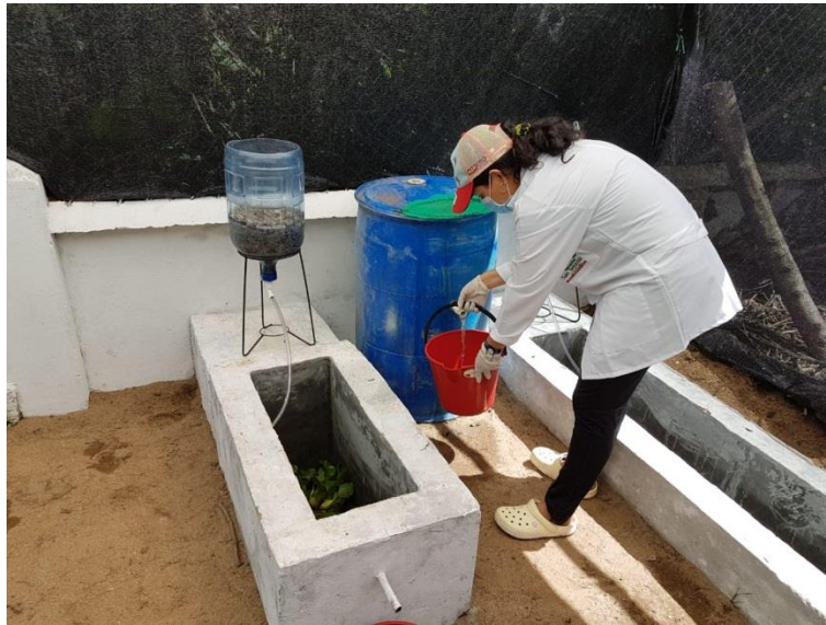
Figura 19. Alimentación de los canales de fitorremediación con el agua residual
