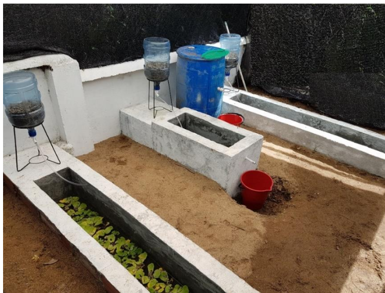
Figura 13. Sistema Piloto de Fitorremediación
