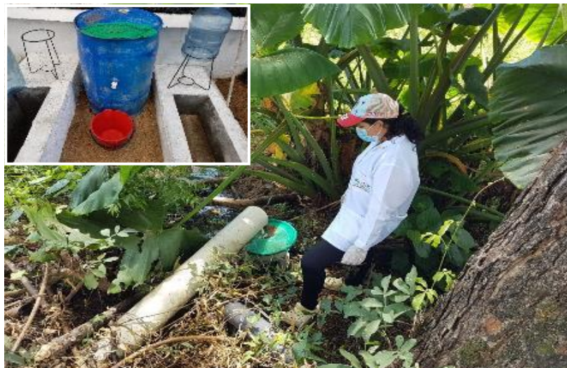
Figura 16 Sedimentador primario y recolección efluente de las porquerizas
