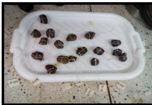
*Figura 16 Método de densidad aparente*
