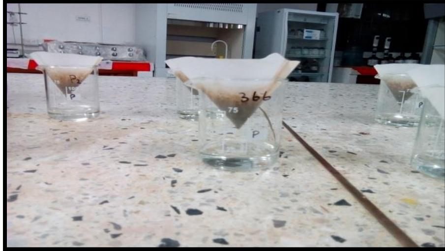
*Figura 17 Prueba de análisis químico, filtrado individual de las muestras*
