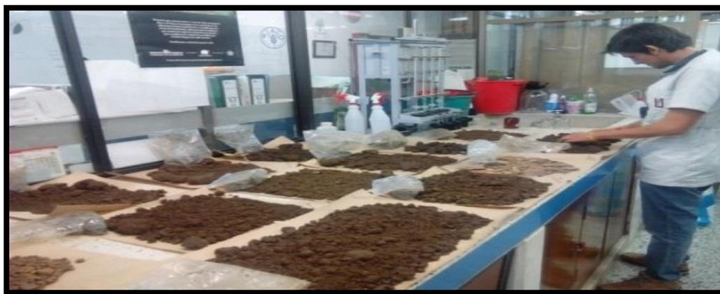
*Figura 14 Extendido y secado de muestra en el laboratorio*
