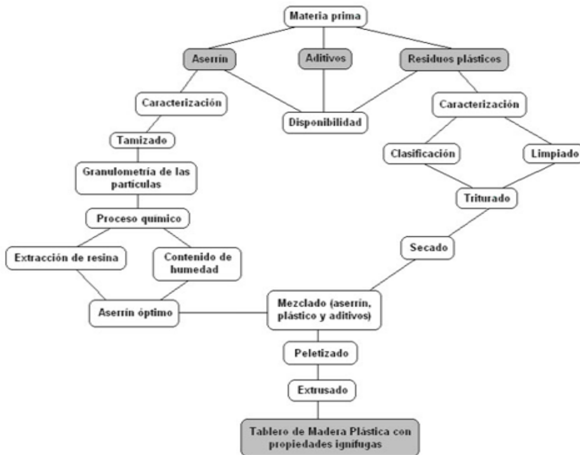
Ilustración 2: Diagrama de flujo del proceso de elaboración de un producto en madera plástica.
