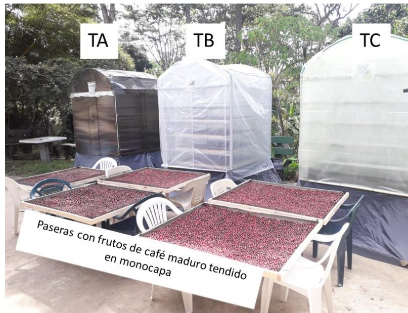
Figura 2. Secadores solares tipo gabinete y paseras con café tendido en fruto maduro. TA: Tratamiento A, policarbonato alveolar. TB: Tratamiento B, tela Prosolar. TC: Tratamiento C, polietileno para invernadero.
