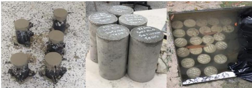
**Ilustración 16.** Encofrado, desencofrado y curado de cilindros
