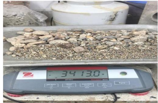
**Ilustración 11** Agregado natural después del desgaste.
