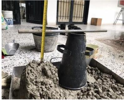
**Ilustración 15** Medición de asentamiento
