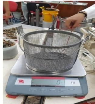
**Ilustración 9.** Recipiente de la muestra para agregado grueso
