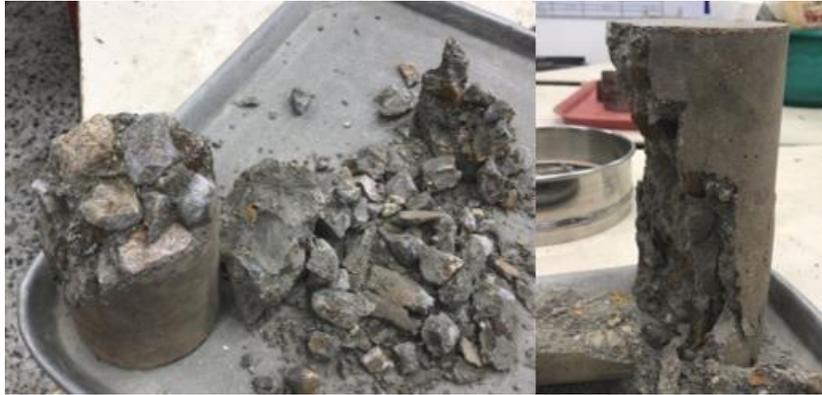
**Ilustración 17.**Detalle falla cilindros muestra AM50%
