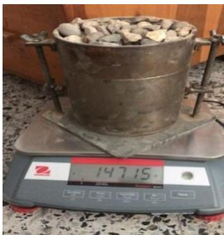
**Ilustración 8.** Molde para ensayo agregado grueso
