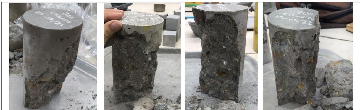
**Detalle de fallas concretos con reemplazo del 70% tratamiento C “Cilindros Usco”**
