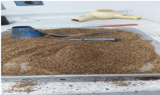
**Ilustración 10.** Ensayo para determinar la humedad superficial del agregado fino
