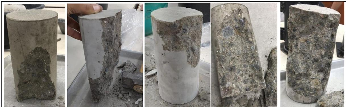
**Detalle de fallas concretos con reemplazo del 70% tratamiento B “Constructora Briñez”**
