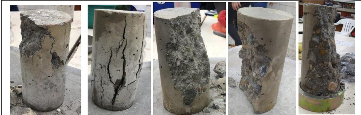
**Detalle de fallas concretos con reemplazo del 70% tratamiento A “Comprados de planta de tratamiento”**
