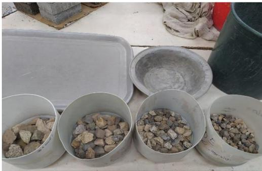
**Ilustración 12.** Agregado según gradación tipo A.
