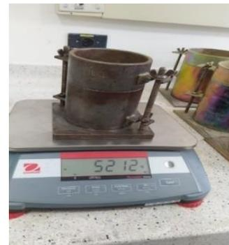
**Ilustración 6.** Molde para ensayo agregado fino
