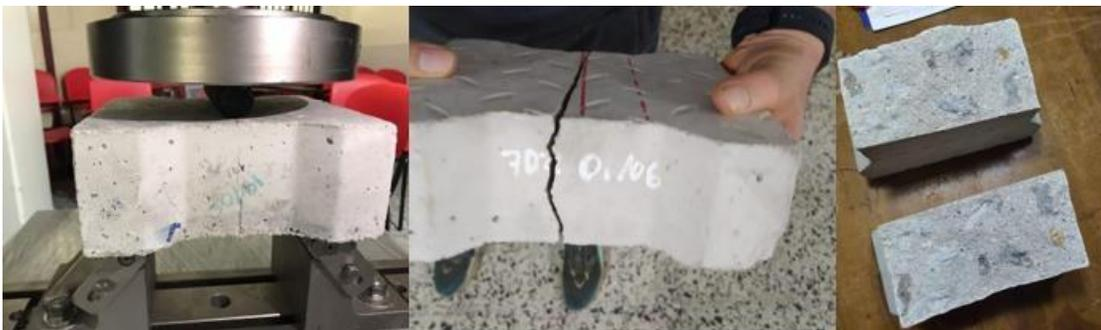
**Ilustración 18.** Ensayo a flexión de adoquines.
