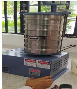
**Ilustración 7.** Tamizadora mecánica
