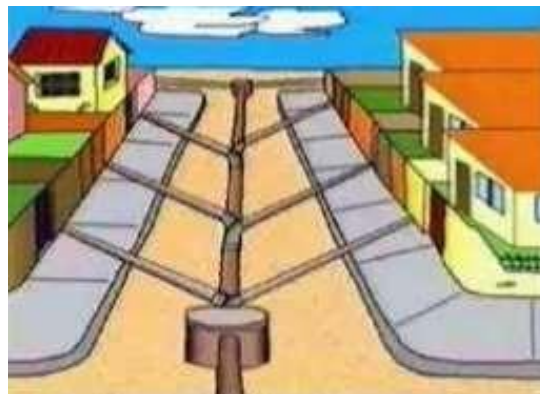
— Figura 2-1: Alcantarillado convencional. Tomado de (Ing. Elder Josue Martinez La Paz Honduras, 2016) ...
