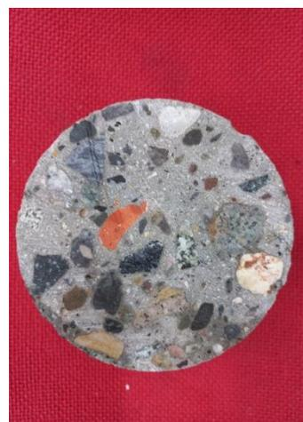
Figura G-14: Distribución de los agregados gruesos en el concreto.
