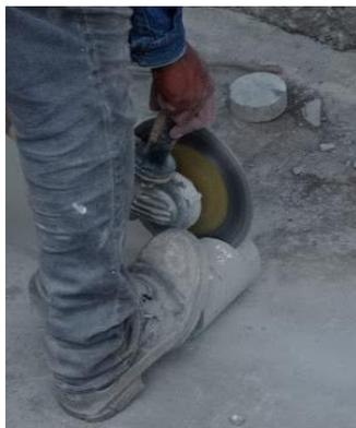
Figura G-11: Corte de un cilindro de concreto.
