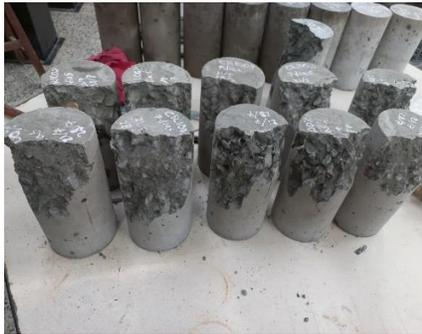
Figura G-9: Especímenes de cilindros fallados.
