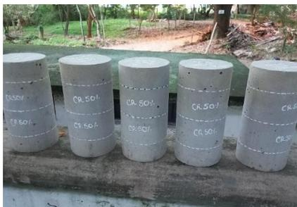
Figura G-12: Marcación de cilindros para cortar.
