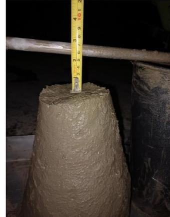
Figura G-4: Determinación del asentamiento en las mezclas de concreteo.
