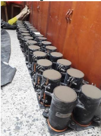
Figura G-5: Muestras de cilindros de concreto en estado fresco.
