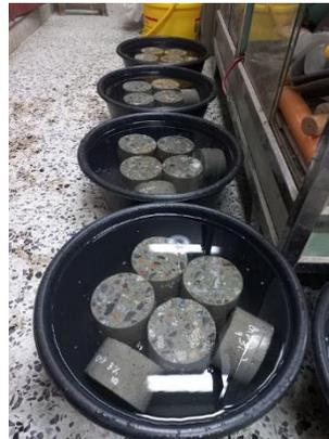
Figura G-13: Cortes de concreto bajo agua.
