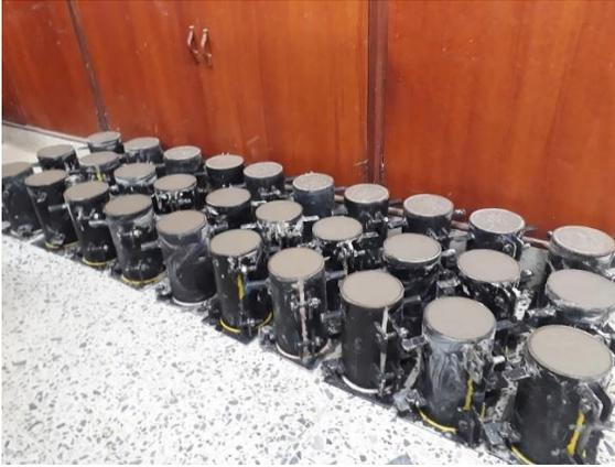
Figura 3-17: Almacenamiento de los especímenes de concreto.
