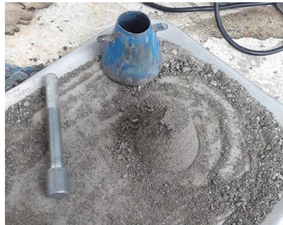
**Figura 3-6:** Molde y pisón para ensayo de humedad superficial.
