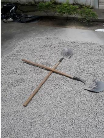
Figura G-1: Cuarteo de la muestra de AGR-C.
