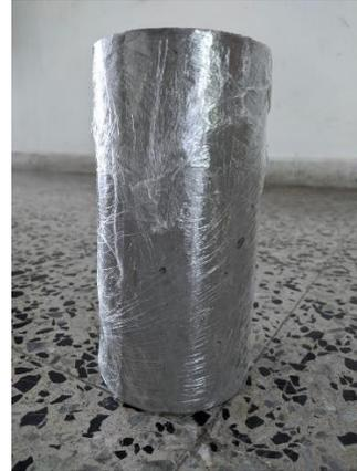
Figura 3-18: Cilindro de concreto cubierto con plástico.
