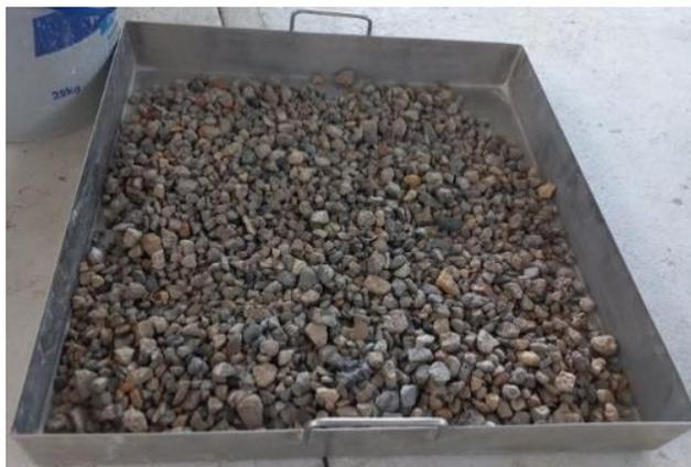
**Figura 3-12:** Agregado grueso reciclado de concreto saturado superficialmente seco.
