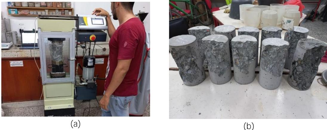
Figura 3-20: (a) Ensayo resistencia a compresión. (b) Especímenes de concreto fallados.
