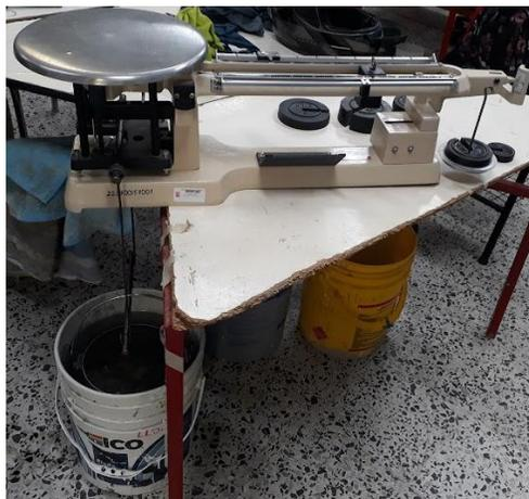
**Figura 3-5:** Montaje para determinar masa aparente en agua.
