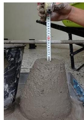
**Figura 3-16:** Medición del asentamiento.
