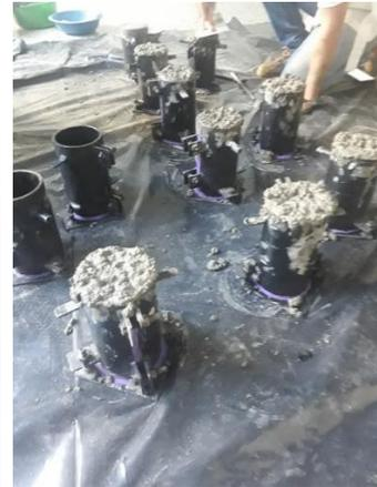
Figura G-3: Elaboración de muestras cilíndricas.
