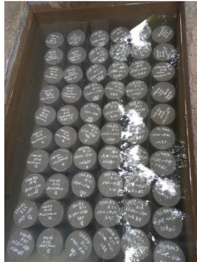
Figura 3-19: Curado por inmersión de los especímenes de concreto.
