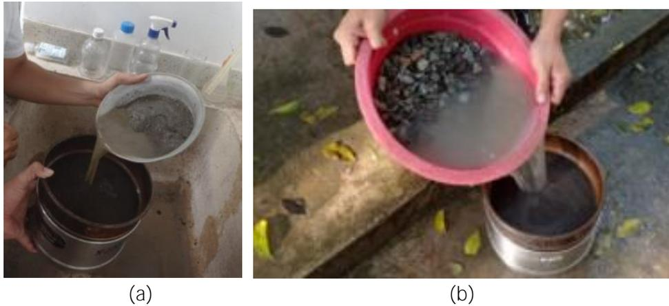
**Figura 3-8:** (a) Proceso de lavado del agregado fino. (b) Proceso de lavado del agregado grueso.
