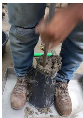
**Figura 3-15:** Ejecución ensayo de asentamiento.
