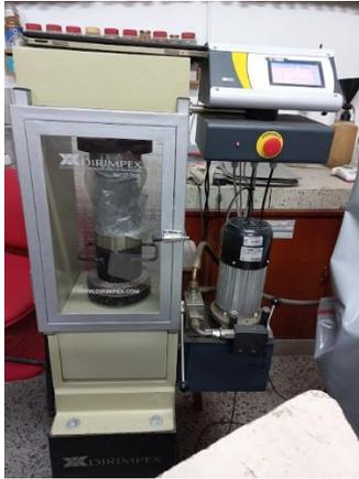
Figura G-8: Ensayo a la compresión.
