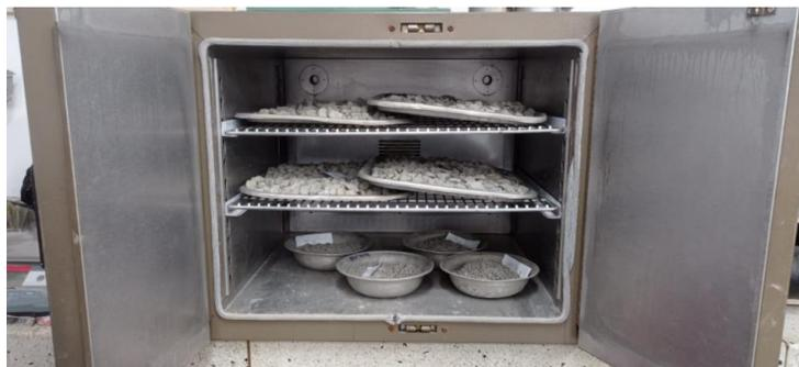
Figura 3-4: Secado del material en el horno.
