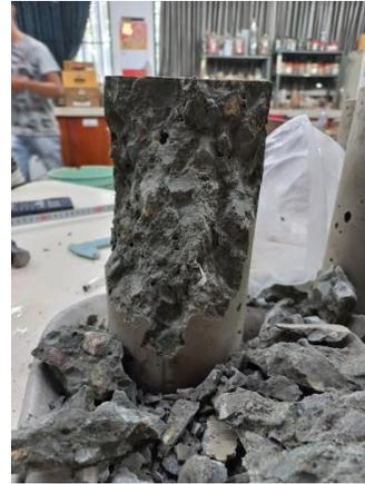
Figura G-10: Presencia de fibras en el concreto.
