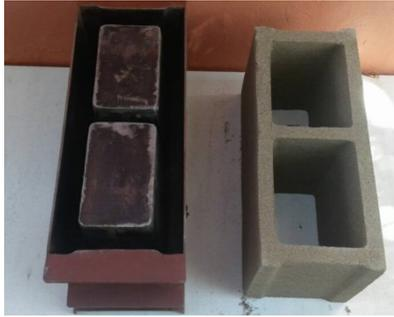
Figura 2-11: Moldes en hierro fundido para bloques de concreto
