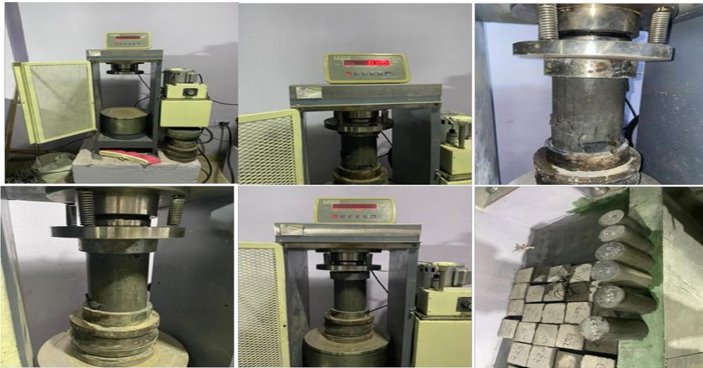
Figura 4-1:Procedimiento prueba compresión a los 7 días.
