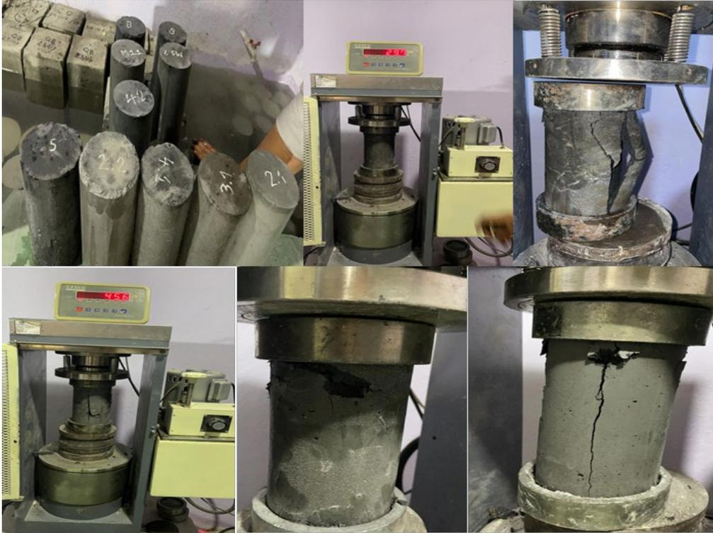
Figura 4-6. Procedimiento prueba compresión a los 28 días.
