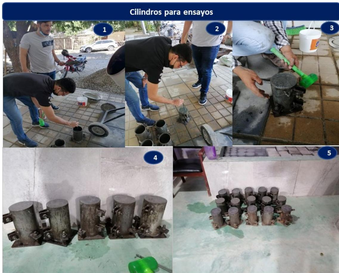
Figura 3-5: Alistamiento de cilindros de ensayo
