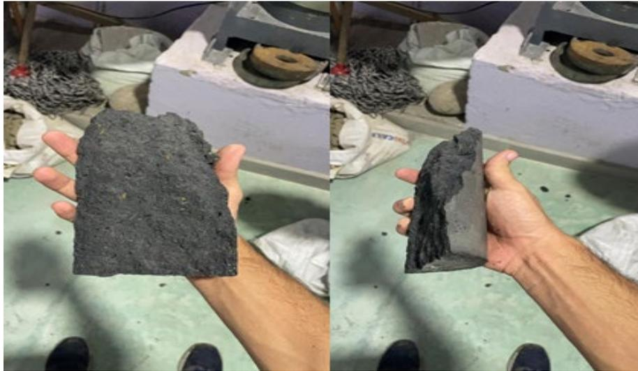
Figura 4-2: resultado de la rotura ensayo M15 relación 30/70
