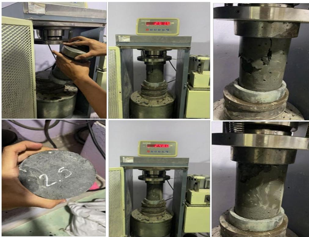
Figura 4-4. Procedimiento prueba compresión a los 14 días.
