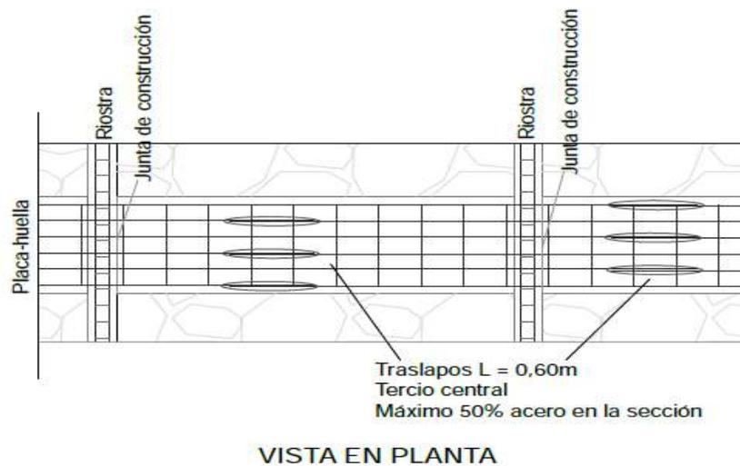
**Figura 4-8.** Junta transversal de construcción en la Placa-huella. Tomado de Guía de diseño de pavimentos con Placa Huella INVIAS.
