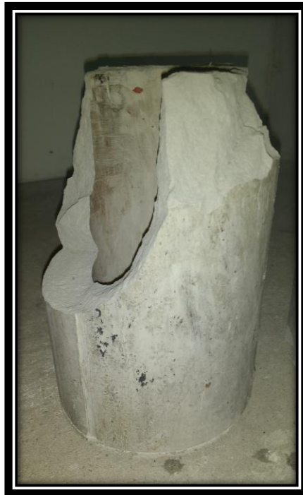
Figura 12. Cemento extraído con golpes fuertes Fuente: Autores
