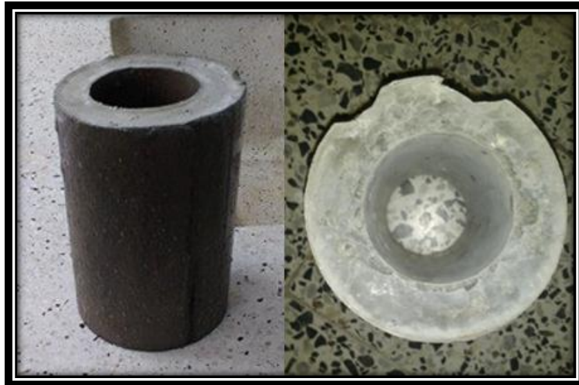
Figura 13. Cemento extraído con golpes suaves y firmes Fuente: Autores
