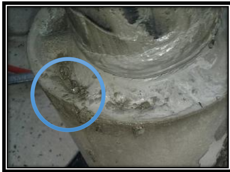
Figura 14. Evidencia de migración de gas en el cemento Fuente: Henríquez y Serrano, 2016 [9]
