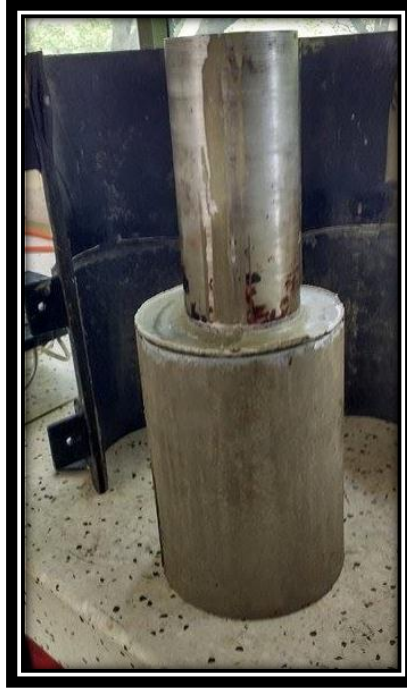
Figura 11. Cemento fraguado alrededor del tubo interior Fuente: Autores
