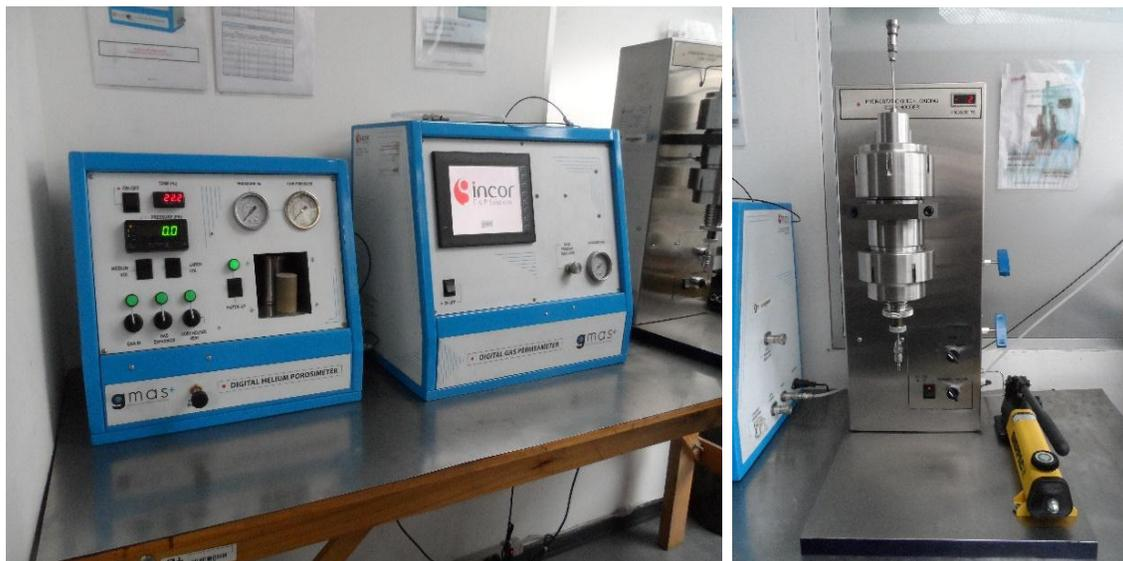
**Fuente.** Perméometro Digital de Gas marca INCOR y Core Holder, Laboratorios GMAS, Bogotá.
