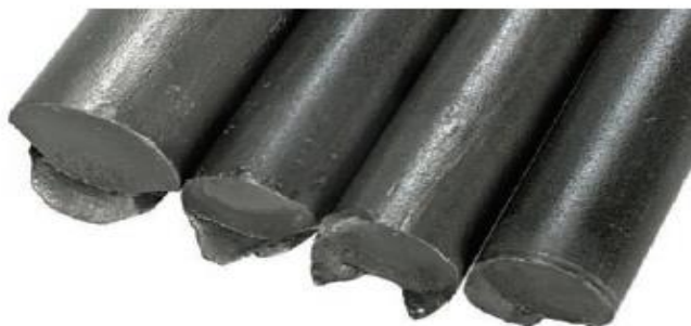
Figura 34. Fallas por daños superficiales.
