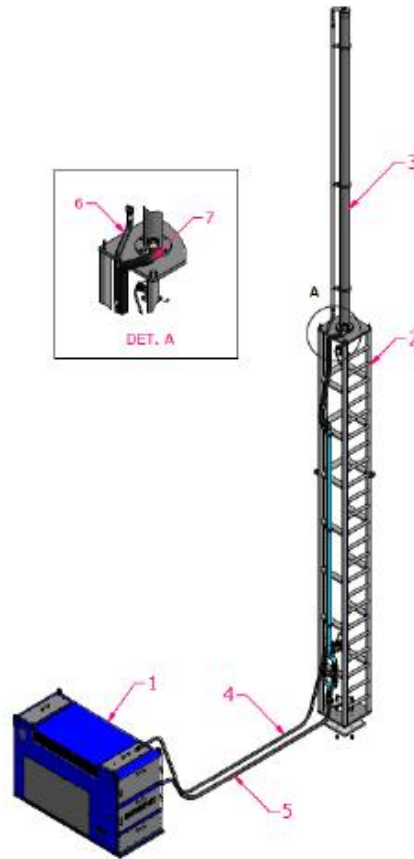
Figura 2. Esquema del equipo de superficie de la UHBM. Fuente: SERINPET LTDA. (2014).Manual UHBM modelo estándar 5.3 V2.
