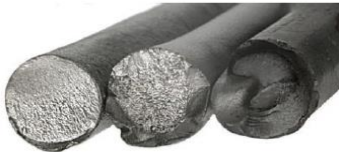
Figura 33. Falla por varilla flexionada.
