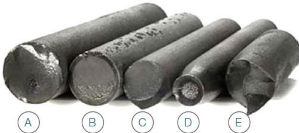
Figura 30. Mecanismos de fallas de varillas.
