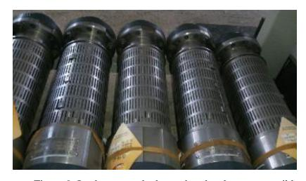
Figura 9. Intake o entrada de una bomba electrosumergible.
