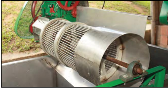
Figura 3. Zaranda Rotatoria (FNC-Cenicafé, 2013)
