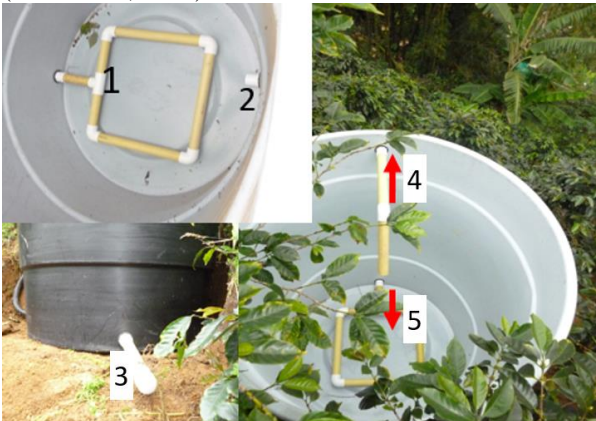
Figura 24.) Reactor Metanogénico y algunos elementos. (Coocentral, 2017).
