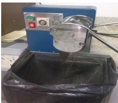
**FIGURA 5.** Trilladora mecánica de café.
