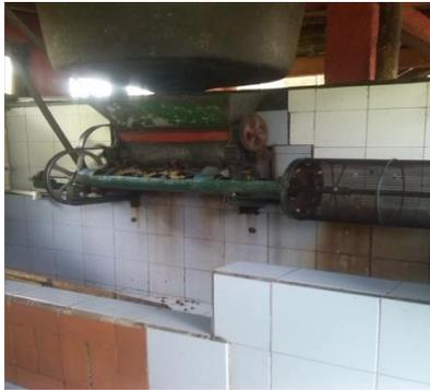
**Figura 2.** Proceso de despulpado de café con maquina mecánica Jotagallo 4 chorros.
