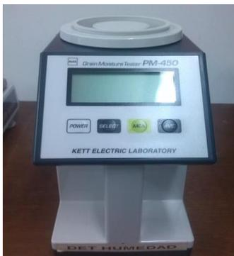
**Figura 3.** Medidor de humedad Moisture Tester PM-4500.
