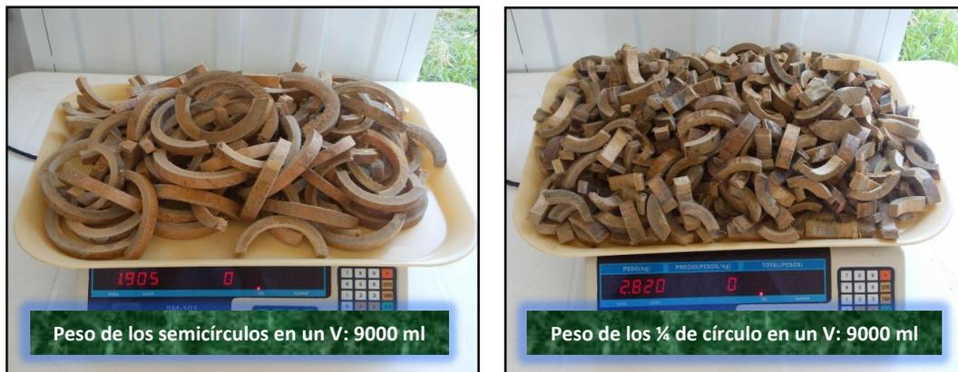
Figura 13. Determinación del peso específico
