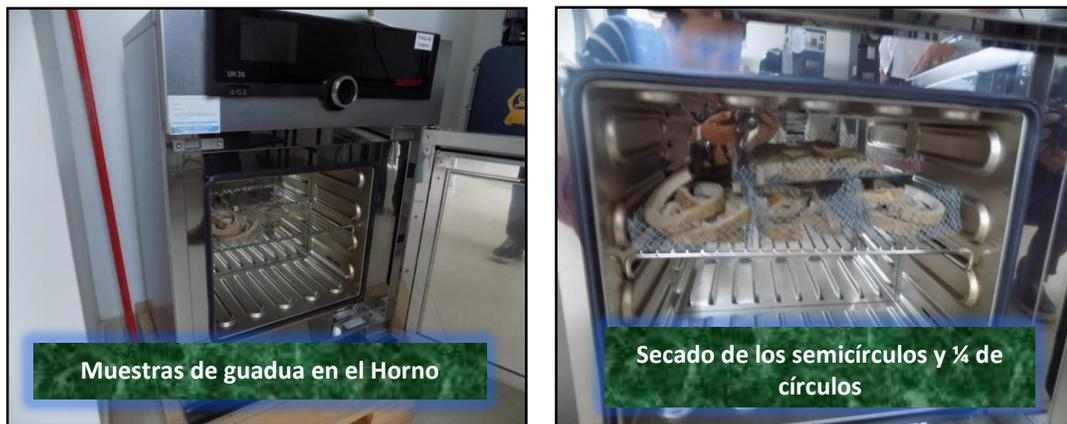
**Figura 11.** Determinación del contenido de humedad
