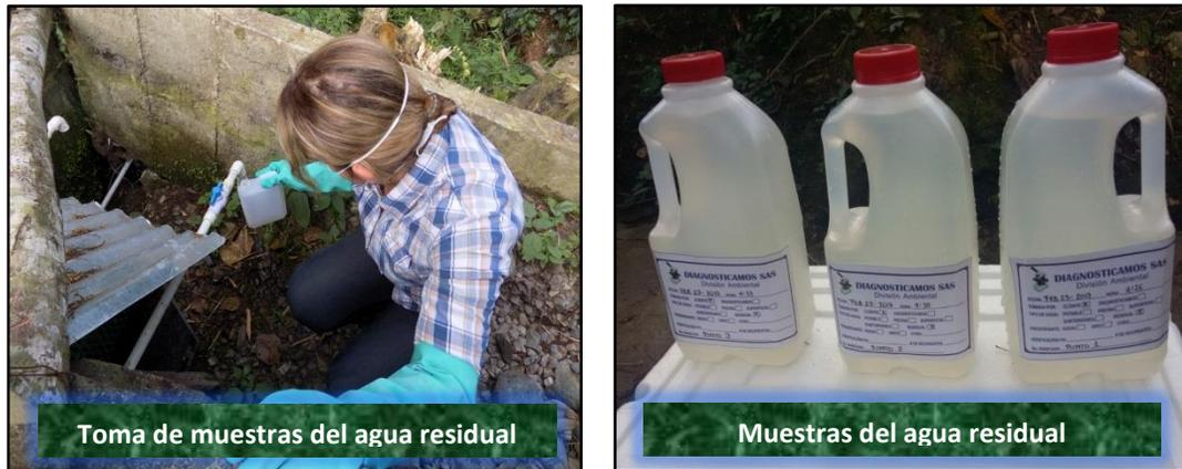
**Figura 23.** Descripción de la toma de muestras del AF y EF
