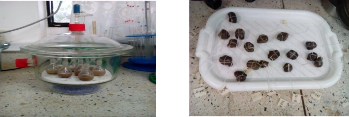
Figura 10. a) Método del Picnómetro y b) Método Terrón Parafinado.
