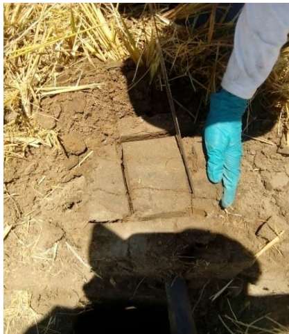
Figura 6. a) Extracción de muestra representativa y b) Selección material de suelo
