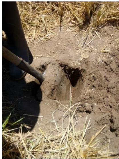
Figura 5. a) Limpieza del sitio de muestreo y b) muestreo del suelo en forma de “V”
