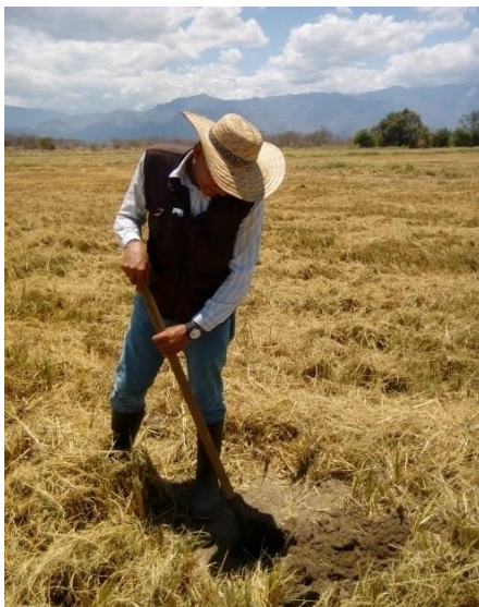
Figura 5. a) Limpieza del sitio de muestreo y b) muestreo del suelo en forma de “V”
