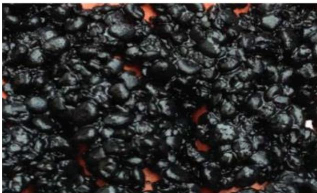
**Figura 4.** Gránulos anaerobios desarrollados en un biorreactor de aguas residuales química a gran escala el tratamiento (Show, *et al.*, 2016).
