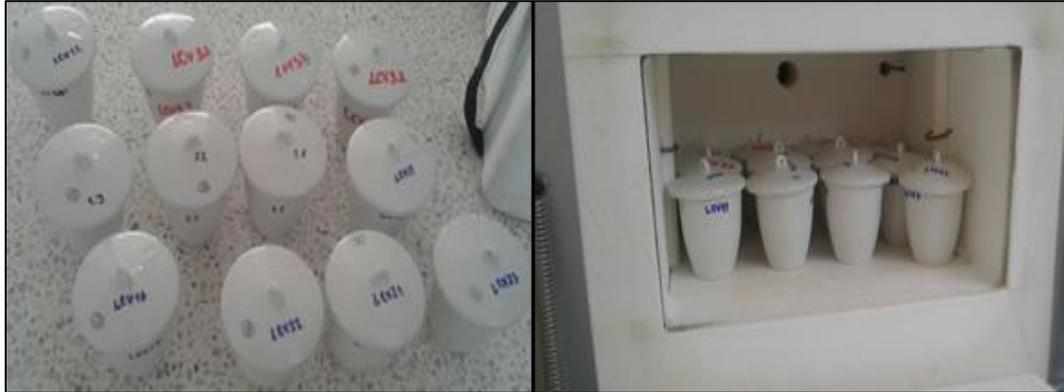
**Figura 12.** Montaje determinación de cenizas
