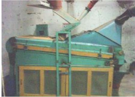
**Figura 12.** Despedregadora trilladora Cafétrilla
