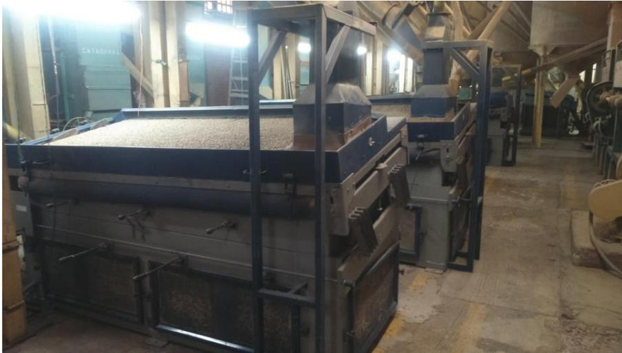
**Figura 17.** Clasificadora densimétrica Pinhalense Trilladora Neiva, Huila
