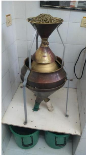
**Figura 29.** Homogenizador boerner
