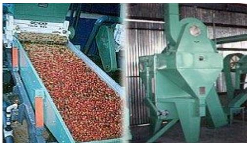
**Figura 4.** Despulpadora industrial Coagrobrisas, El Pital
